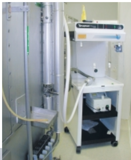
Abb. 3: MD8 airscan mit speziellem Metall-Filterhalter für Gelatinefilter-Einweeinheiten in Captair Flowcap 700 Cleanbench über PVDF Schlauch mit Bottlepack Maschine Typ 3012 verbunden. Standort: Firma Excelvision, Annonay, Frankreich.
