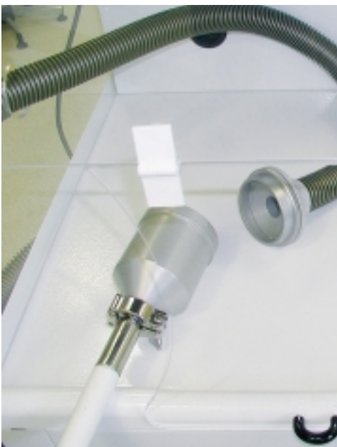
Abb. 3: MD8 airscan mit speziellem Metall-Filterhalter für Gelatinefilter-Einweeinheiten in Captair Flowcap 700 Cleanbench über PVDF Schlauch mit Bottlepack Maschine Typ 3012 verbunden. Standort: Firma Excelvision, Annonay, Frankreich.
