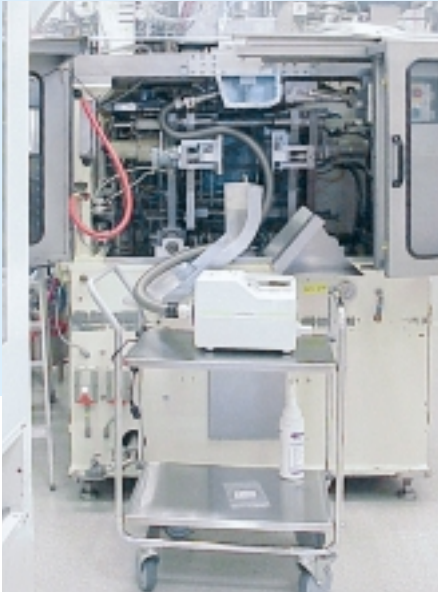
Abb. 2: Bottleneck Maschine mit fest adaptiertem Filterhalter in der Nähe der Abfüllzone und Luftkeimsammelgerät MD8 airscan. Standort: Firma Holopack, Abtsgmünd-Untergröningen.
